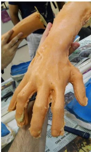
SEGUNDO TESTE COM A GELATINA, QUE É UM MEIO DE BAIXO CUSTO PARA TESTAR SE HÁ DEFORMIDADES NA PEÇA. É EXTREMAMENTE PRÁTICA, POIS PODE SER DERRETIDA E UTILIZADA OUTRAS VEZES. DETALHES DOS DEDOS, ONDE PODEMOS OBSERVAR QUE HOUVE DEFORMIDADE DEVIDO À PRESSÃO DAS PEÇAS TEREM SIDO FRACA.
