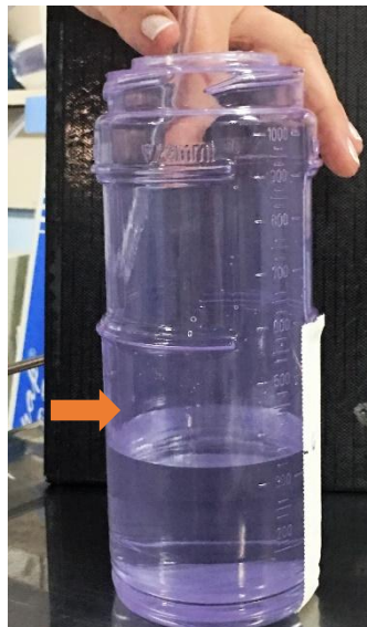
Figura 18- encha o frasco com água destilada até a marcação de 6 cm .
