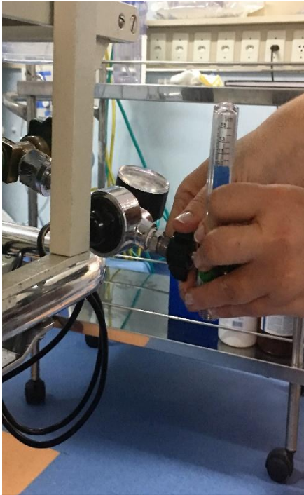
Figura 21 - Ajuste o Fluxômetro nos cilindros de Oxigênio e ar comprimido
