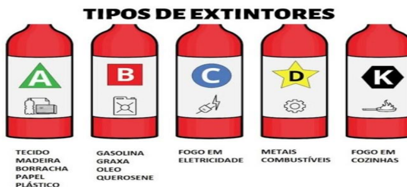
Figura 8 – Tipos de extintores
