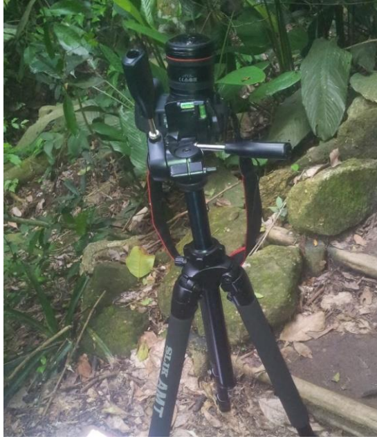
Figura 8 – Câmera CANON EOS 6D acoplada a uma lente Fisheye 8mm, com suporte de tripé
