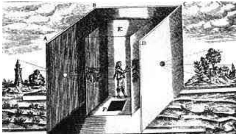
Figura 1 – Grande Câmara Escura em forma de liteira, construída em Roma 1646 por Athanasius Kircher.
