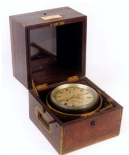
Figura 24 - Cronômetro de Marinha. Fabricante John Poole - Acervo MAST 1994/0369. Este cronômetro nº de fabricação 2977 fez parte da mesma expedição de 1882, em Punta Arenas. (CRULS, 1887, p.48).
