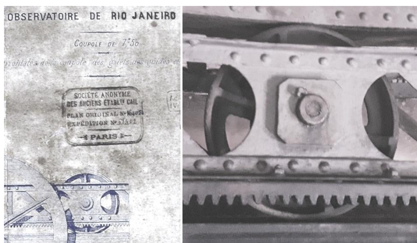
Figuras 79 e 80 - Detalhe da (ON PL 0051 pl 01) projeto de manivela e roldana de rotação. Observatoire do Rio de Janeiro – Coupole de 7,50. Société Anonyme des Anciens Etablissements Cail - plan original nº 164054 – expedition nº 68402 – Paris. Acervo MAST; e na figura 80 imagem roldana da cúpula 21 MAST, 2019, fotografia da autora.
