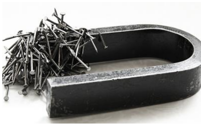
Figura 6: Ímã em formato de ferradura atraindo pregos de material ferromagnético.
