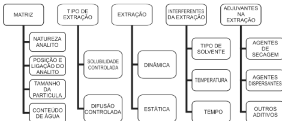
Figura 5 – Parâmetros de otimização a serem considerados para escolha do processo de extração (Mustafa, a & Turner, C, 2011).
