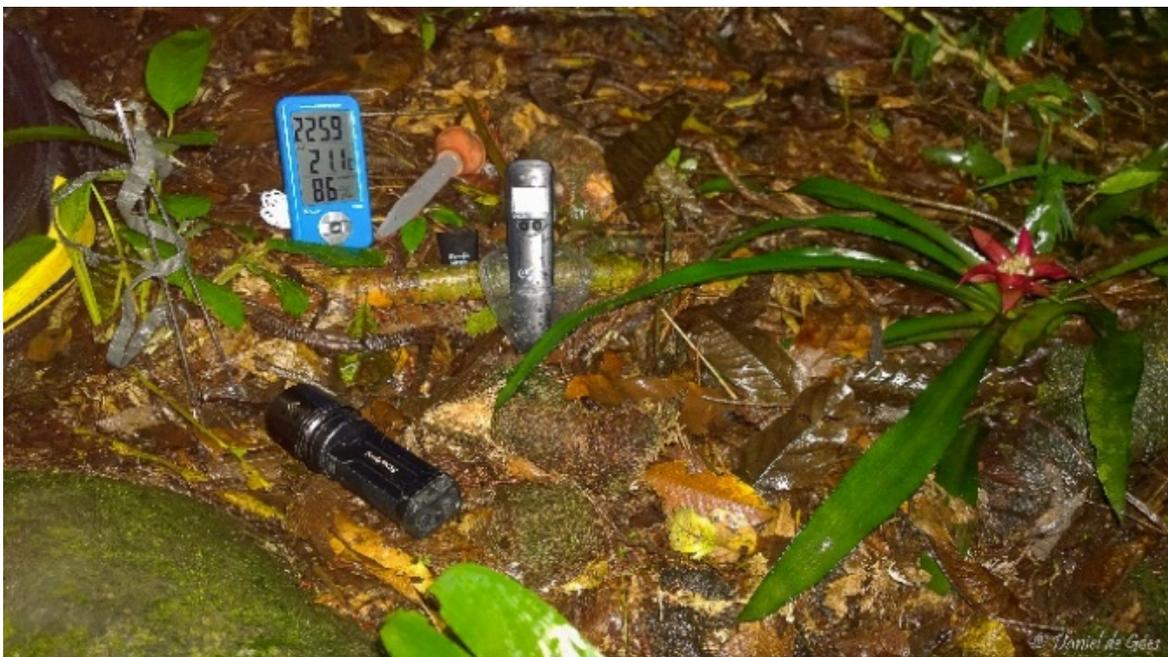
**FIGURA 3.** Equipamentos utilizados para inferir os parâmetros ambientais (Termo-higrômetro digital minipa mt-240, PHmetro Hanna HI98130).
