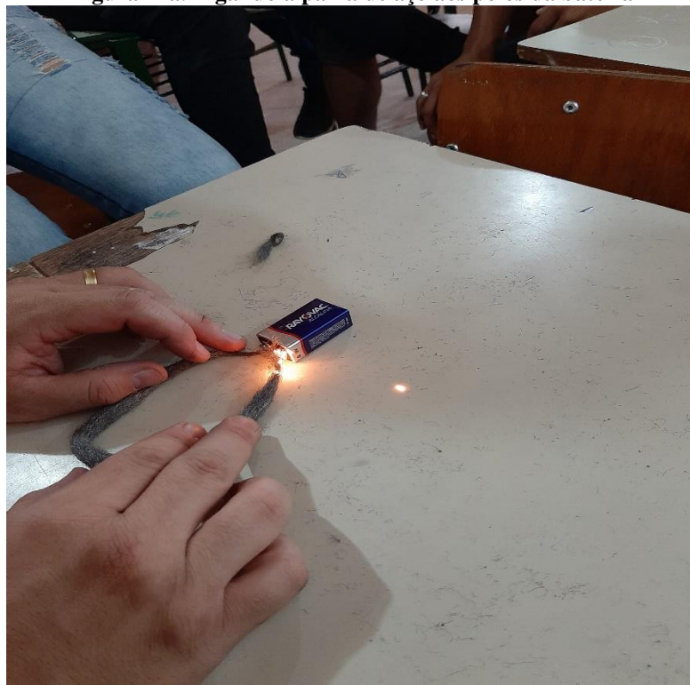
Figura 27a. Ligando a palha de aço aos pólos da bateria
