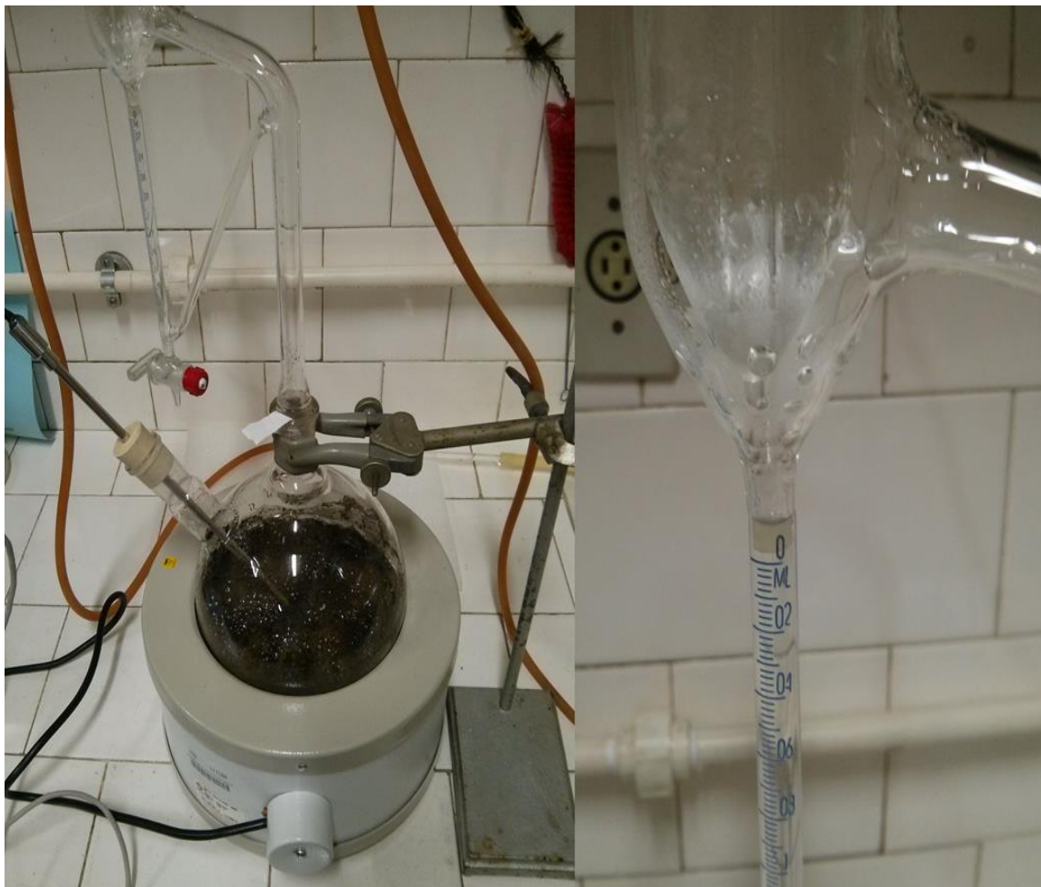
Figura 5. Aparelho de Clevenger durante a extração do OE.
