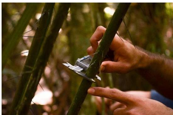
Figura 4: Medição do diâmetro do caule à 1,30m do solo utilizando o paquímetro digital. Parque Estadual dos Três Picos e Reserva Ecológica de Guapiaçu, Cachoeiras de Macacu, RJ. 2019.
