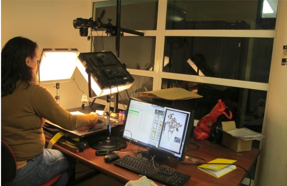
**Figura 6** – Digitalização de uma amostra utilizando o equipamento Canon EOS 5D lente compact-macro EF 50 mm.
