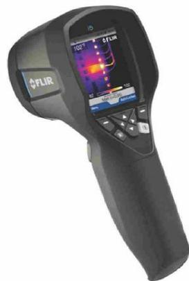
**Figura 10:** Câmera termográfica FLIR i7®
