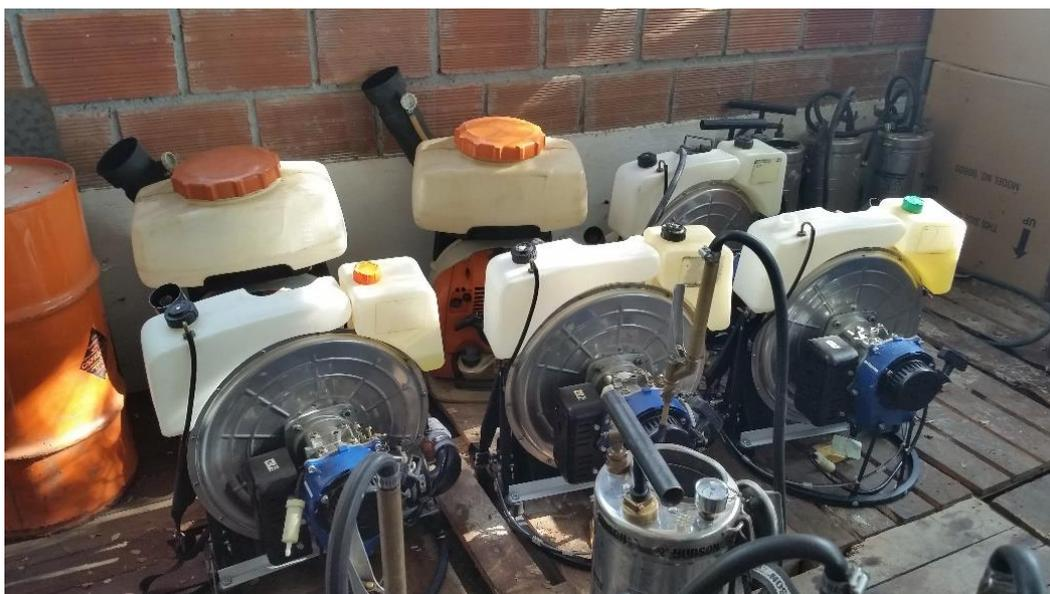
Figura 36: Fotografia do equipamento em formato de mochila utilizado para aplicação de nuvem de inseticida intradomiciliar, Neiva, 2014.
