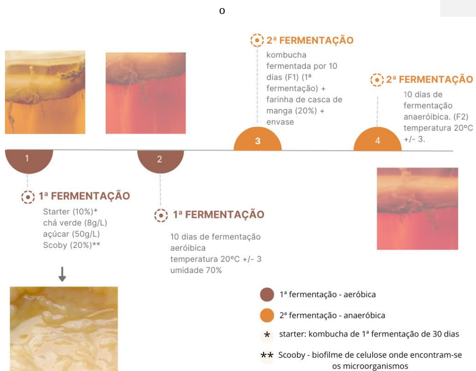
Figura 2. Representação gráfica do processo de produção da kombucha usada em todo o projeto.
