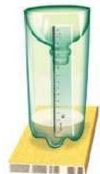
Figura 21: pluviômetro de plástico.
