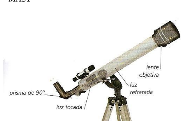
Imagem 11: Estrutura óptica de um telescópio refrator (luneta)
