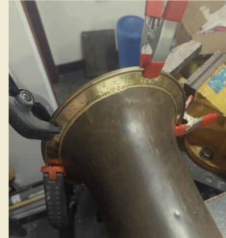
Figura 21: instalação do anel na campana do oficleide
