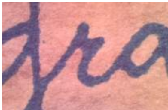
Figura 38 - Fotomicrofotografia de amostra da planta ON.PI.0051 – planta 10, é possível observar que as linhas azuis pousam na superfície do papel devido à emulsão. A imagem foi ampliada com auxílio do microscópio (aumento de 400x). Acervo MAST. (foto da autora, 2011). 85
