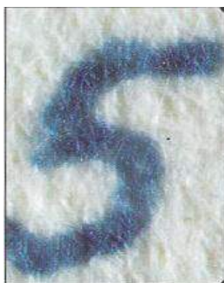
Figura 16 - As linhas azuis na impressão Pellet pousam levemente no topo da superfície do papel, devido à emulsão colorida, em que os sais encravados podem ser vistos quando olhados sobre ampliações de 15x. Imagem: KISSEL e VIGNEAU, 1999, p. 61. (Foto da autora, 2010)
