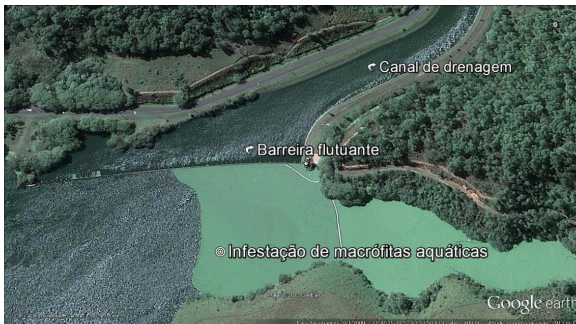
Figura 4. Barreira flutuante localizada à entrada do canal de drenagem do reservatório do Vigário.
