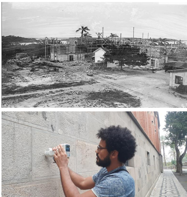
Figura 114: Medição para monitoramento das alterações da cor do granito por meio de espectrofotômetro de cor
