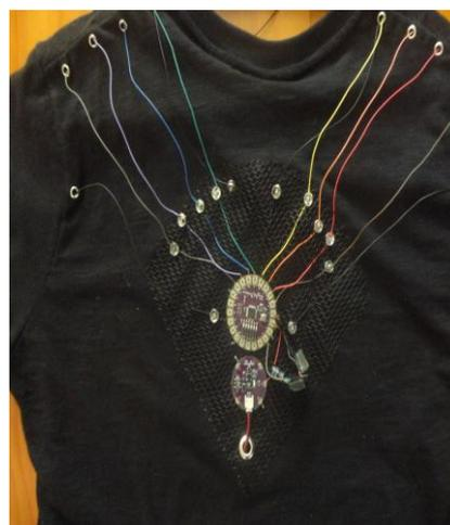
b) costas, com exibição dos fios dos circuitos, mas com a bateria embutida
