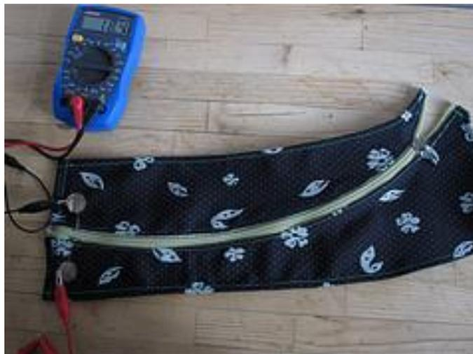
Figura 20. Potenciômetro em forma de zipper
