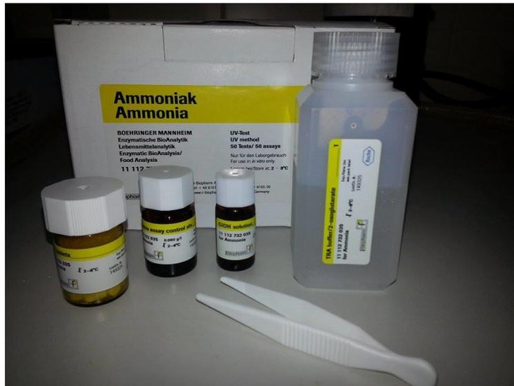
Figura 6: Kit enzimático para determinação de amônia.
