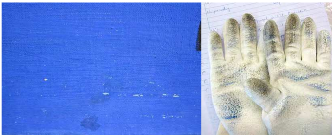
Figura 30. Ilustração dos termos powdering/chalking no Modern Paint Damage Atlas .
