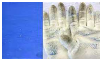
Pulverulência de camada pictórica, transferida para luvas,
