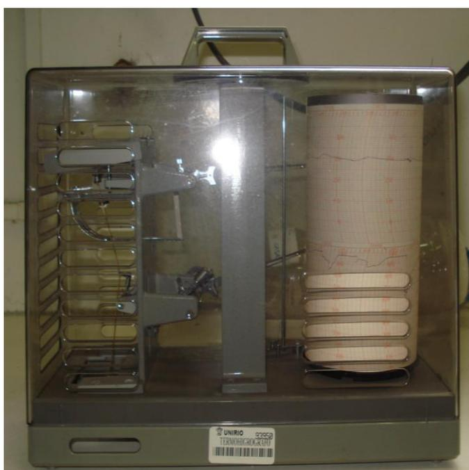
FIGURA 2 ) Termohigrógrafo para registro da temperatura e Umidade relativa do Ar inserido dentro da capela de criação na primeira etapa experimental.
