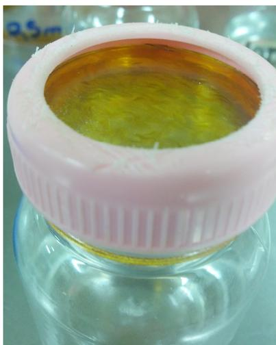
**Figura 4.** Células de permeação utilizadas na análise de permeabilidade ao vapor de água com o filme a base de 10% de FFH na superfície.
