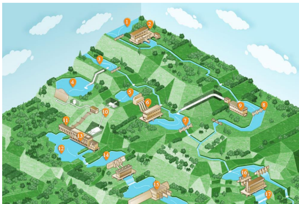
Figura 3. Representação esquemática do Complexo Lajes de reservatórios da Light. 1- Reservatório de Santa Branca, 2 – Usina Hidrelétrica de Santa Branca, 3- Reservatório de Tócos, 4- Reservatório de Lajes, 5 – Reservatório de Vigário, 6- Usina Elevatória de Vigário, 7 – Reservatório de Santana, 8 – Reservatório de Santa Cecília, 9 - Usina Elevatória de Santa Cecília, 10 - Usina Hidrelétrica Nilo Peçanha, 11- Usina Hidrelétrica Fontes Nova, 12- Reservatório Ponte Coberta, 13 - Usina Hidrelétrica de Fontes Velha, 14 - Usina Hidrelétrica de Pereira Passos, 15 - Pequena Central Hidrelétrica de Paracambi, 16 - Reservatório Ilha dos Pombos, 17 - usina Hidrelétrica de ilha dos Pombos. Adaptado de http://www.light.com.br/grupo-light/Empresas-do-Grupo/light-energia.aspx .
