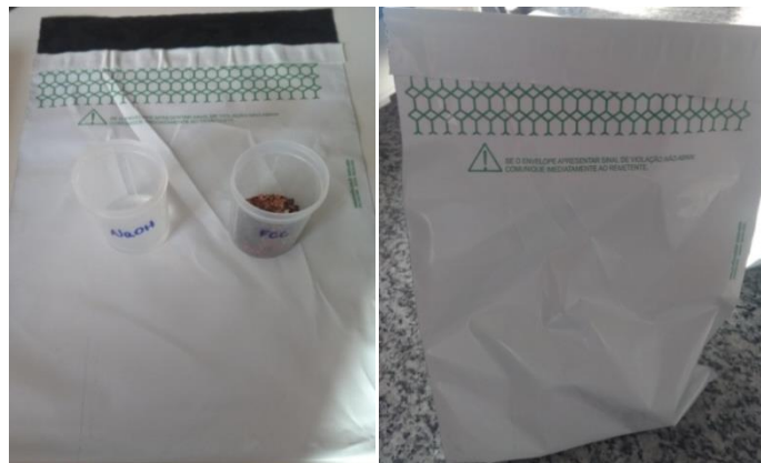
Figura 1: Incubação da amostra e solução NaOH para determinação Respiração basal (RBS).
