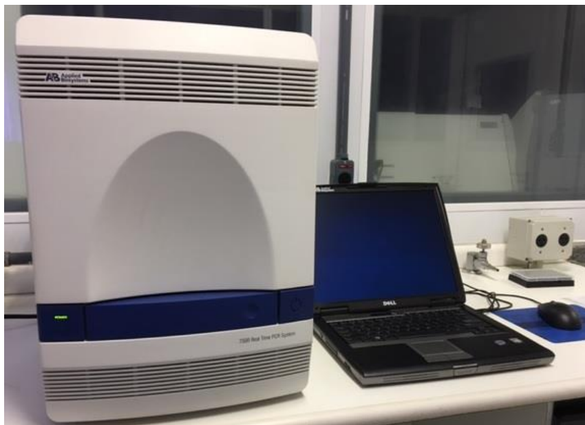
Figura 5 - Termociclador acoplado à computador com software para coleta e análise de dados
