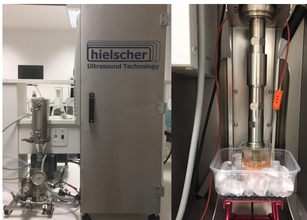
Figura 2 - Aparelho de Ultrassom de ponteira com amostra submersa em banho de gelo para extração dos compostos bioativos
