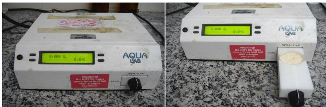
Figura 12. Equipamento para determinação da atividade de água
