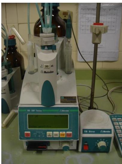
Figura 10. Titulador automático para medição de pH e acidez
