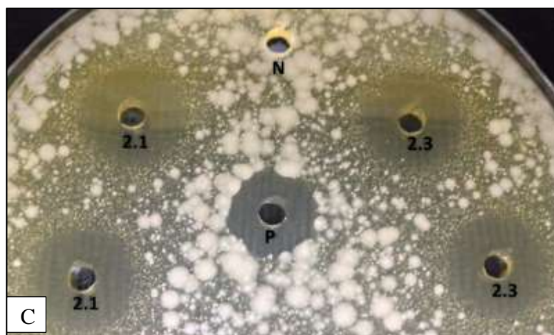
Figura 14 Halos de inibição: bactérias Gram-positivas pelo Método de difusão em poços de ágar (PEPSINA)
