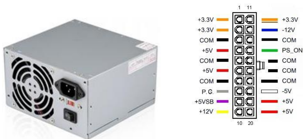
Figura 45 – Fonte de alimentação e seu conector padrão
