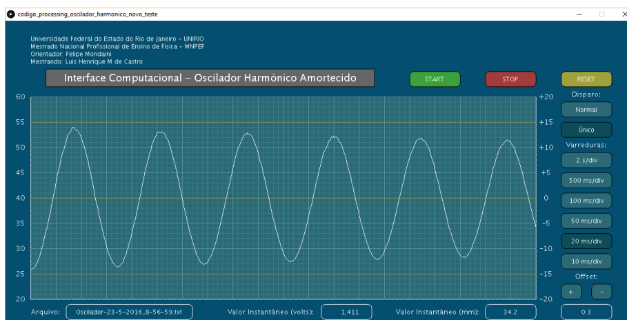
Figura 30 – Oscilação na interface computacional para um balanço da régua de 20 cm
