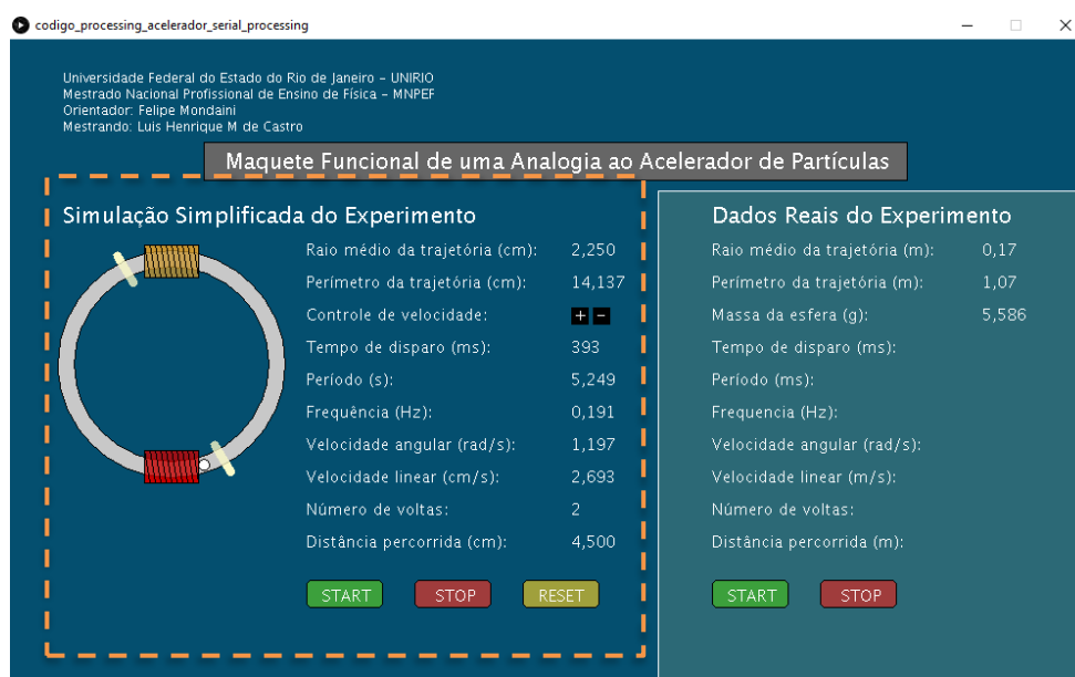
Figura 51 – Atividade 1 – Detalhe do simulador na interface computacional do experimento
