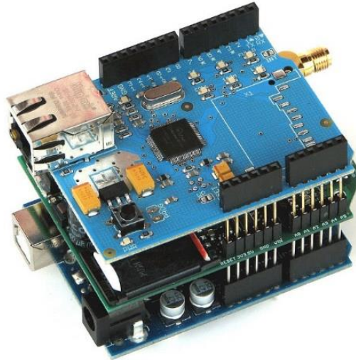
Figura 5 – Exemplo de conexão de shields em uma placa Arduino UNO Fonte: Hardware & Related Initiatives em www.arduino.cc , consultado em 29/07/2016
