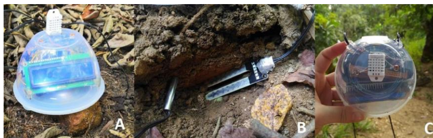
Figura 10: (a) Robô “Q”; (b) sensor de umidade do solo do “Q”; (c) sensor de luminosidade do “Q”.
