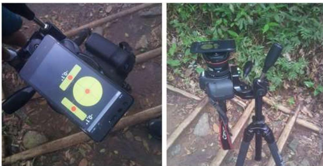
Figura 20 – Registro de fotografia hemisférica capturada com auxílio de nível de bolha e bússola. Monumento Natural dos Morros do Pão de Açúcar e da Urca, Rio de Janeiro, RJ.
