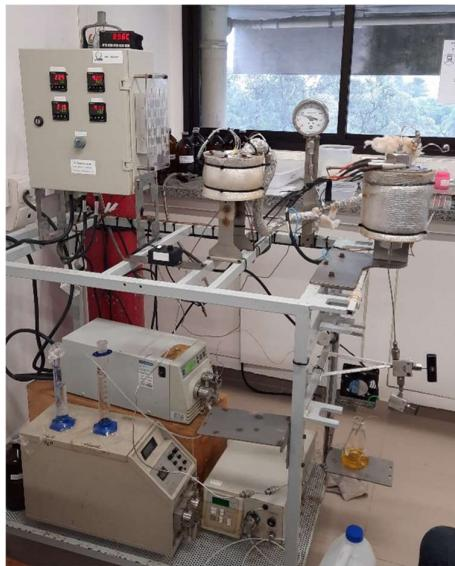
Figura 9: Equipamento desenvolvido para extração por líquidos pressurizados (LATESC/UFSC). Fonte: autoria própria.
