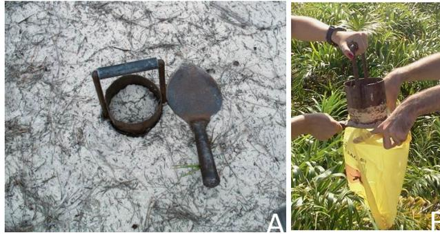
Figura 5: **A:** Extrator de coleta; **B:** Acondicionamento das amostras.
