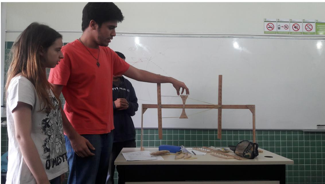
Figura 63 - Alunos utilizando o kit para demonstrar o comportamento de raios notáveis para uma lente bicôncava de índice de refração menor do que o meio que está imersa
