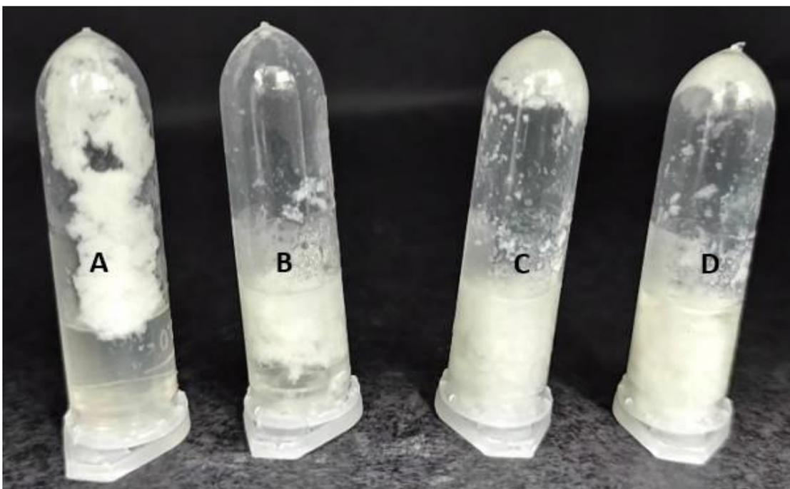
Figura 5 — **Foto demonstrativa do efeito da concentração de cloreto de cálcio sobre a atividade coagulante da protease de sementes de noni.** (A) – Concentração de CaCl<sub>2</sub> 10mM; (B) - Concentração de CaCl<sub>2</sub> 50mM; (C) - Concentração de CaCl<sub>2</sub> 100mM; (D) - Concentração de CaCl<sub>2</sub> 500mM. Fonte: Próprio autor.
