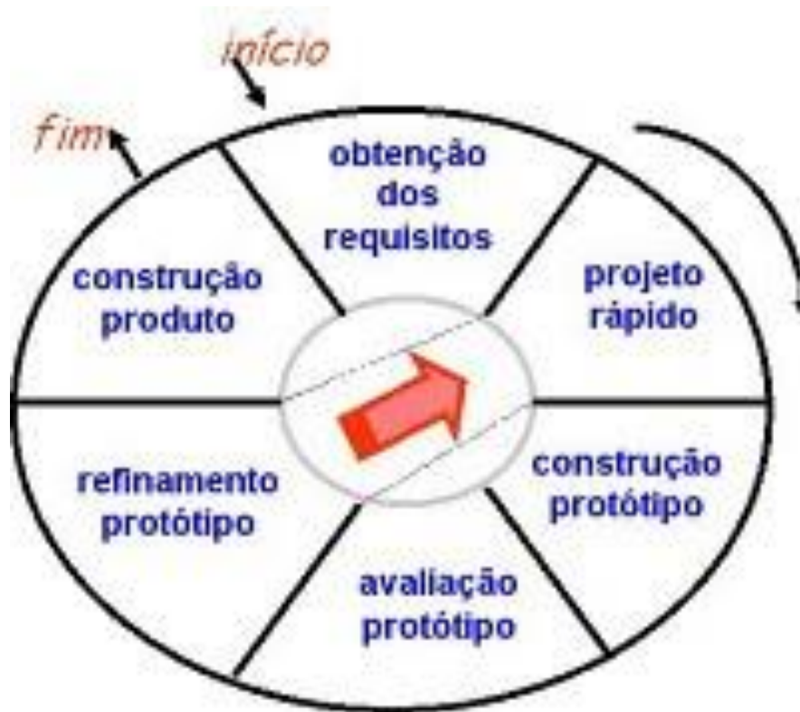
Figura 2 – Prototipação segundo Pressman(1995). Modificado de Figura de Prototipação. In: PRESSMAN, R.S. Engenharia de software. 3ed., São Paulo: Pearson Makron Books; 2011.
