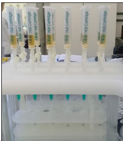
Figura 1: Extração das amostras de cerveja em cartuchos Oasis ® HLB
