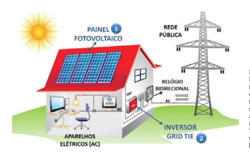
Figura 1 – Esquema de instalação de painéis fotovoltaicos na rede elétrica através de um inversor solar "Grid Tie" e um relógio bidirecional.
