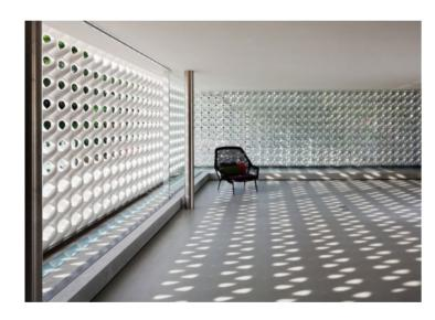
Figura 11 - Utilização de cobogós para melhorar a iluminação e ventilação natural.
