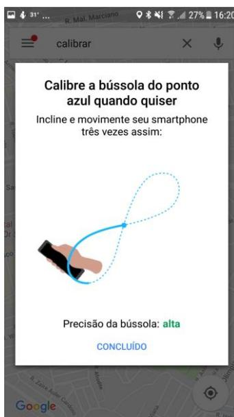
Figura 11: Calibração da bússola eletrônica por meio do aplicativo Google Maps.
