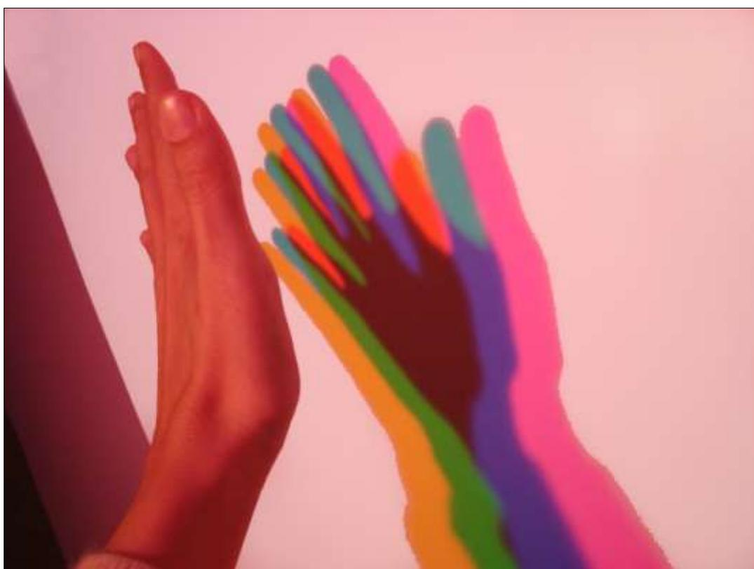
fig.75 - Experimento que decompõe a cor luz branca, para apresentar a soma das cores que a compõem através da projeção sobreposta de feixes de luz colorida.
