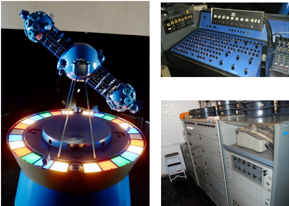
Figura 8 (a, b, c) - projetor Spacemaster , mesa de comando e armários elétricos. Fotos do autor 2018
