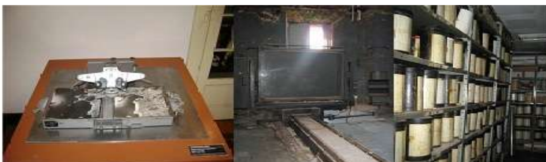
Figura 9: Instrumentos Técnicos. Da esquerda para direita: Estereotopo Zeiss -Restituídor fotogramétrico. Alemanha,1956 ; Klinscher Super Autohonica 101- Câmera Fotográfica: utilizada para originais fotogramétricos de grandes dimensões gerando imagens de até 1,0 x 1,0m, redução e reprodução de cartas; Filmes dos Vôos USAF- Cobertura aérea de todo território brasileiro.
