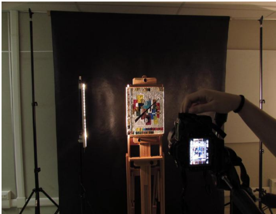
Figura 15 - Aplicação da técnica de luz rasante. Fonte: Márcia Rizzuto – Núcleo de Apoio à Pesquisa de Física Aplicada ao Estudo do Patrimônio Artístico e Histórico / NAP – FAEPAH - USP 153 .
