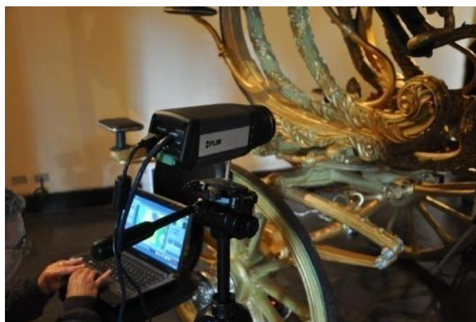
Figura 31 - Análise com câmera digital de infravermelho e a captação de imagem em tempo real no microcomputador. Fonte: Laboratório de Conservação e Restauração do Museu Imperial/IBRAM.
