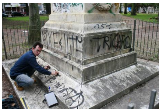
Figura 34 - Análise com ultrassom para verificar o estado de degradação e a resistência do material, no monumento a Giuseppe e Anita Garibaldi. Fonte: Verônica di Benedetti 169 .
