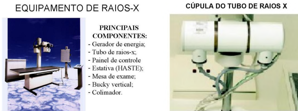
Figuras 23 e 24 - Equipamento de raios X com os seus principais componentes e detalhe da cúpula do tubo de raios X. Fonte: Eduardo Jesus 156 .
