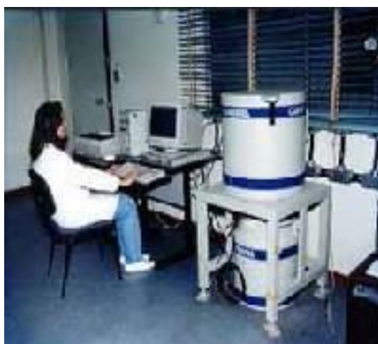
Figura 45 - Equipamentos de análise PR ativação de nêutrons. Fonte: Instituto de Pesquisas Energéticas e Nucleares – IPEN.
