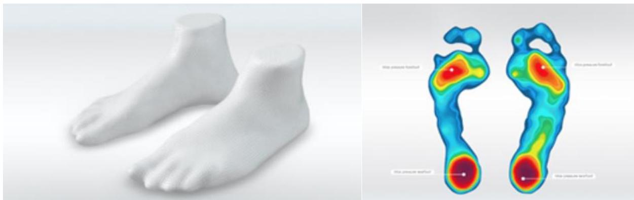
**Figura 4.** Escaneamento 3D de pés e baropodometria digital para confecção de palmilhas.
